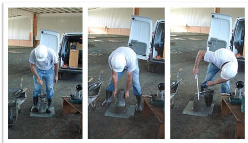
2.10.6. A trabalhabilidade depende, além da consistência do concreto, de características da obra e dos métodos adotados para o transporte, lançamento e adensamento do concreto;
